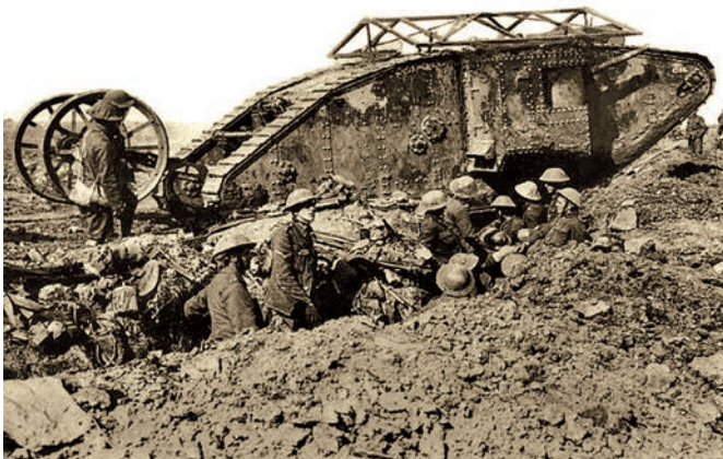
Танк Mk I «самец» во время битвы на Сомме, 25 сентября 1916 г. На крыше видна рама, на которую натягивалась «противогранатная» проволочная сетка.
