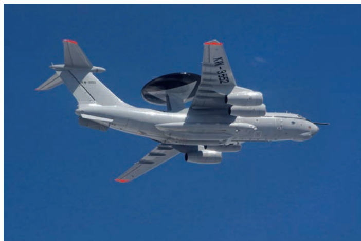
Второй серийный А-50ЭИ, принятый ВВС Индии в марте 2010 г. Самолет имеет трехантенную РЛС EL/W-2090 израильского производства. Фото: https://www.pinterest.co.uk/pin/528258231264052888/
