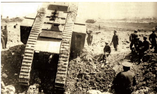
Танк Mk III «самец», Бовингтон. Видна крыша корпуса и открытая дверь правого спонсона
