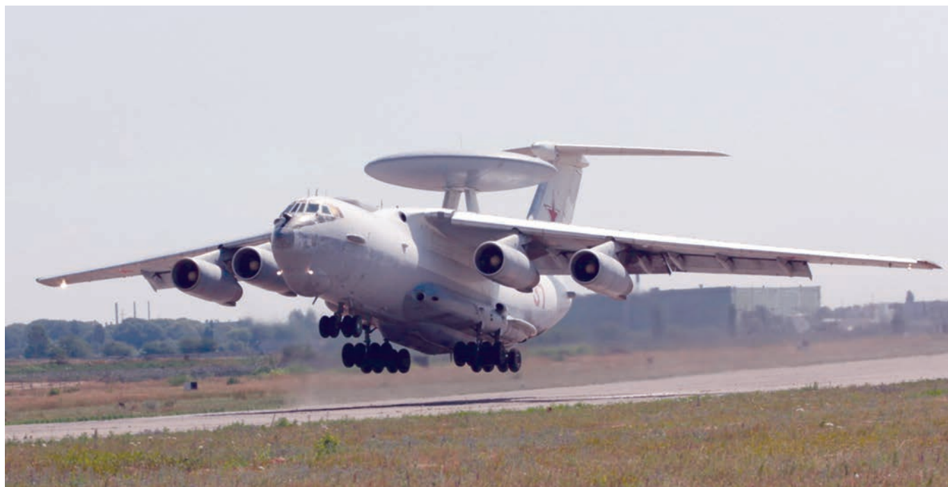
Головной модернизированный самолет РЛДН А-50У борт 37 с радиотехническим комплексом «Шмель-М» . Фото: http://www.donnews.ru/TANTK-im-G-M-Berieva-peredal-VVS-Rossii-modernizirovannyi-samolet-razvedchik_14709
