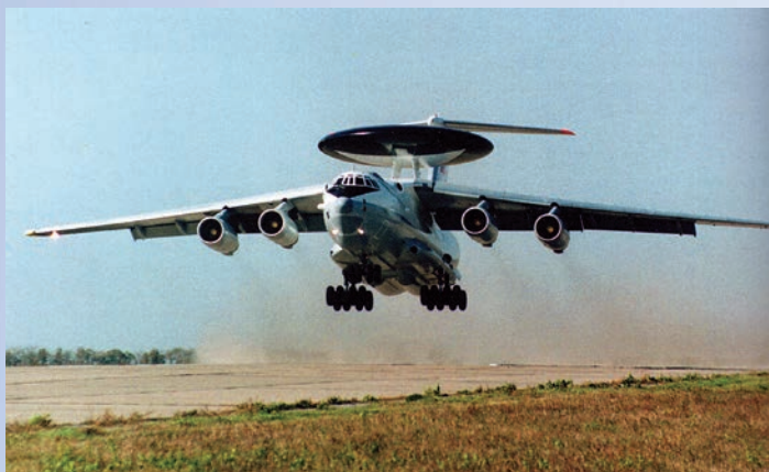
Опытный самолет радиолокационного дозора «АИ» с израильским РТК ELTA MSA, созданный по заказу Китая на базе серийного А-50.
