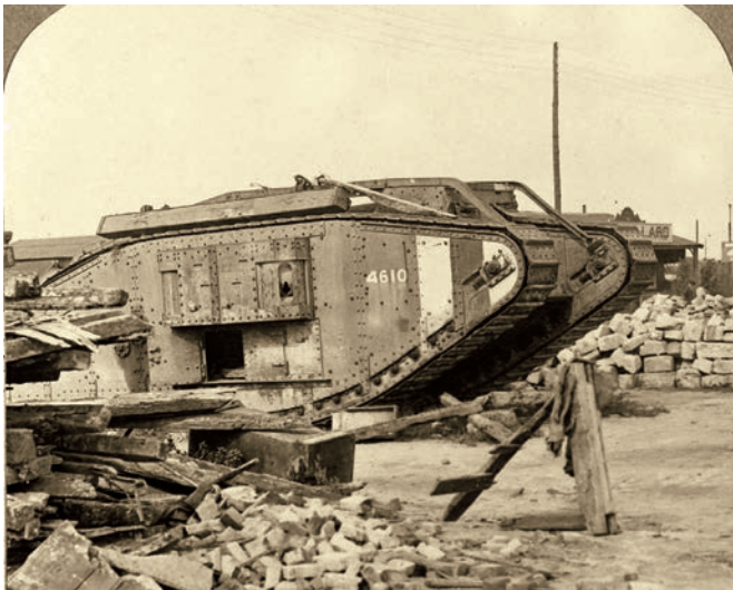
Танк Mk IV «самка», битва при Амьене, 1918 г. Под спонсоном хорошо виден прямоугольный люк-лаз с двустворчатыми крышками
