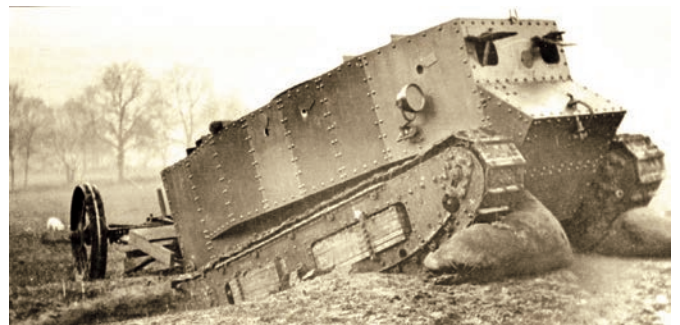
«Маленький Вилли» получил модифицированную ходовую часть с гусеницей, которая не провисала при преодолении траншей
