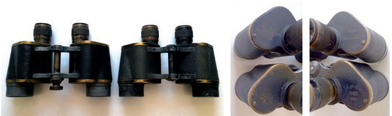
Бинокли Б-1 ГОМЗ с винтом фиксации межокулярного расстояния выпуска 1930 г. и без винта 1934 г.
