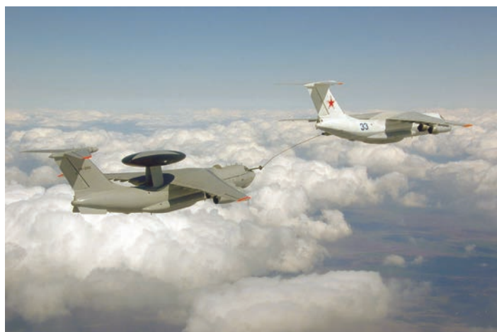
Испытания системы дозаправки топливом в полете второго серийного самолета ЭИ ВВС Индии от танкера Ил-78М ВВС России. Фото: https://www.pinterest.ca/pin/318981586084164616/
