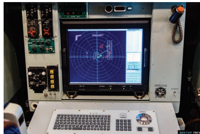
Отображение тактической информации на пульте РТК «Шмель-М» самолета РЛДН А-50У. Фото: http://www.russiadefence.net/t4867p125-awacs-command-control-aircrafts-of-ruaf
