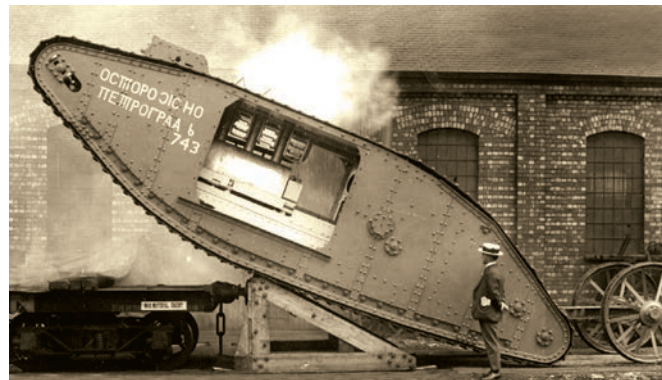
Погрузка одного из первых танков Mk I на платформу. Для перевозки по железной дороге бортовые спонсоны снимались. На танке надпись «осторожно ПетрограаЪ» (с ошибкой), сделанная в рамках дезинформации
