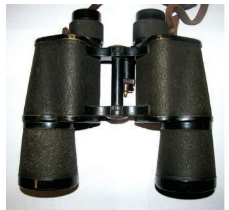
Бинокль БТ 7 x 50 с подсветкой угломерной сетки, 1945 г. выпуска. Из коллекции Владимира Сендецкого
