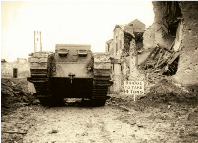
Британский танк со шпорами — уширителями трактов на гусеницах, апрель 1917 г.
