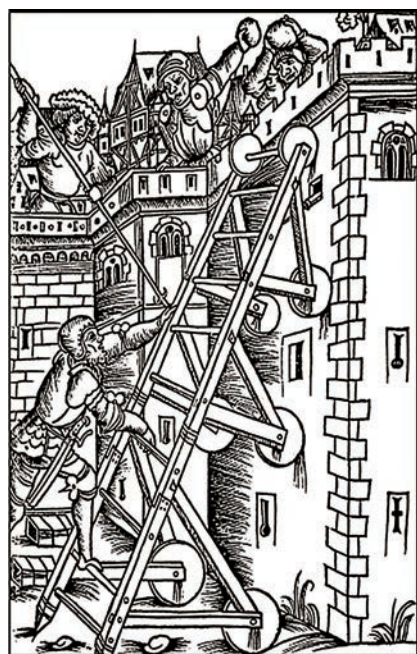
Удлиняющаяся осадная лестница и лестница на колесах из средневековых военных трактатов
